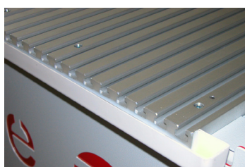
Piano di lavoro in lega di alluminio Extruded aluminium working table
